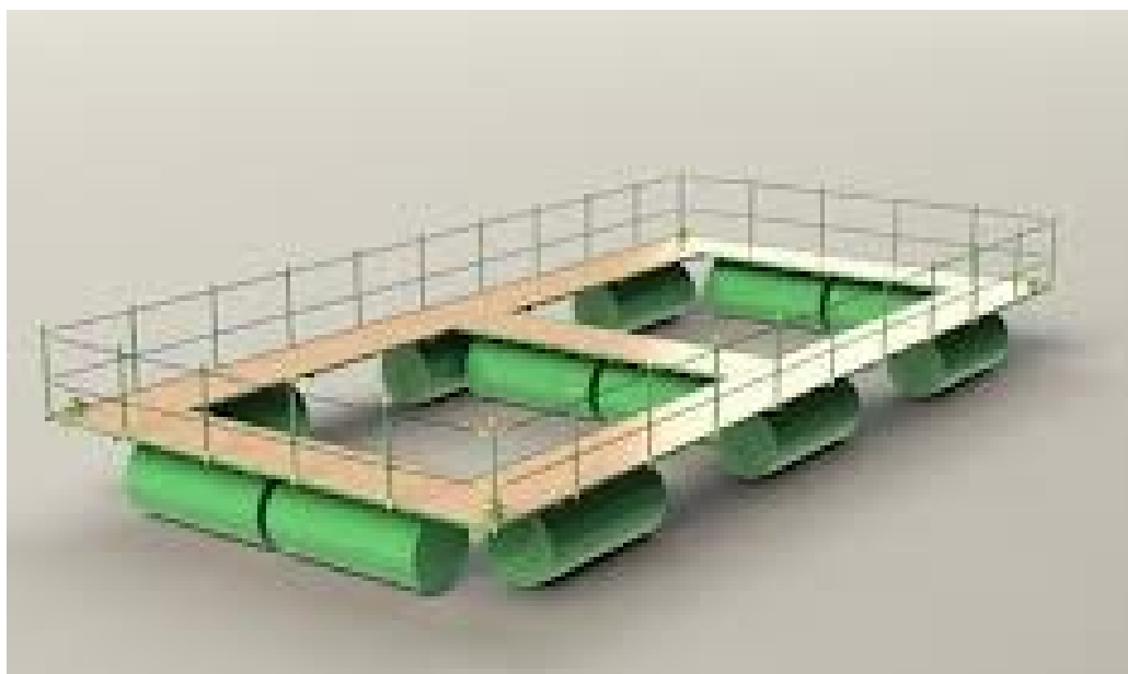
Рисунок 56 – Конструкция понтонных садков
